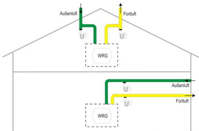
Abb. 27: Anordnung Entwässerung der Außen- und Fortluftleitung
