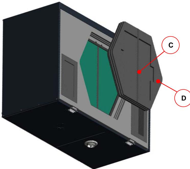
Abb. 39: Herausziehen der EPP-Schaumstoffabdeckung
