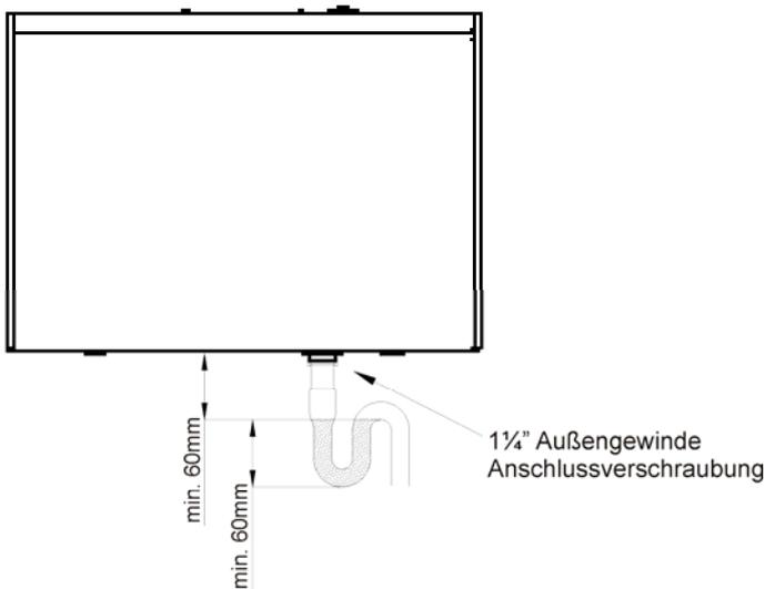
Abb. 29: Kondensatanschluss (Version LINKS)
