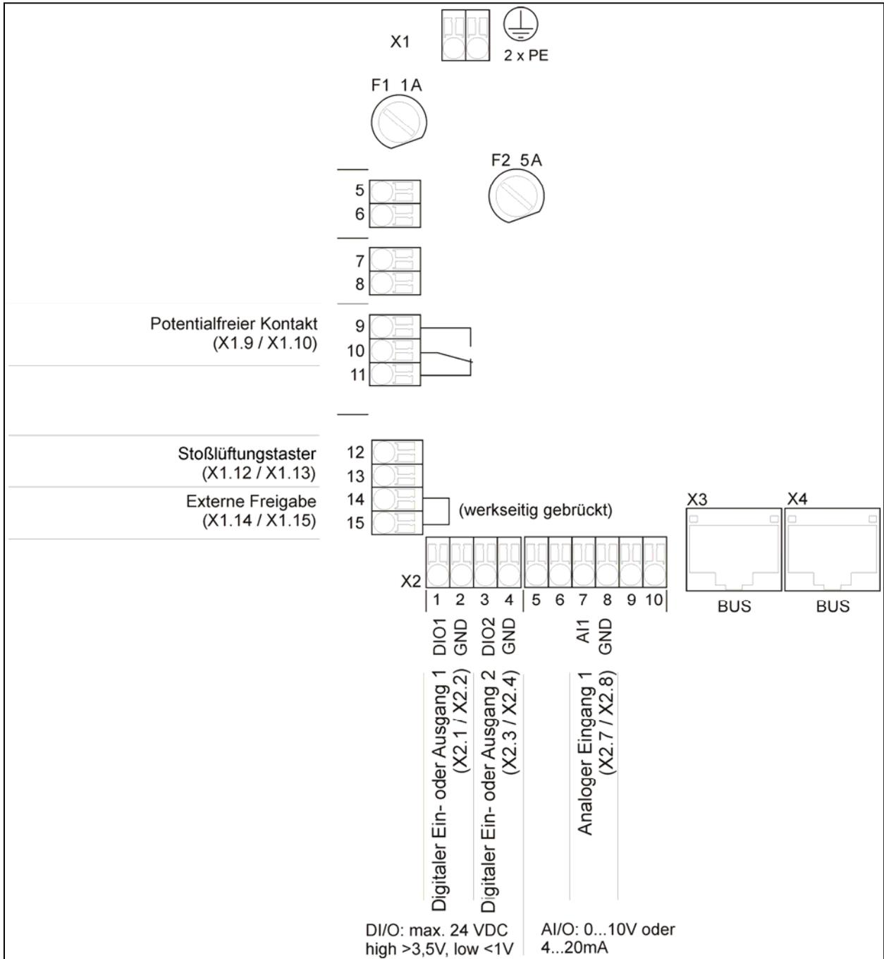
Abb. 45: Klemmenbelegung Master-Controller
