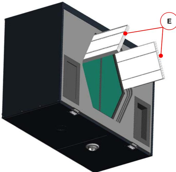
Abb. 12: Herausziehen der Filter
