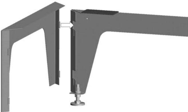
Abb. 21: Aneinandersetzen der Fußteile
