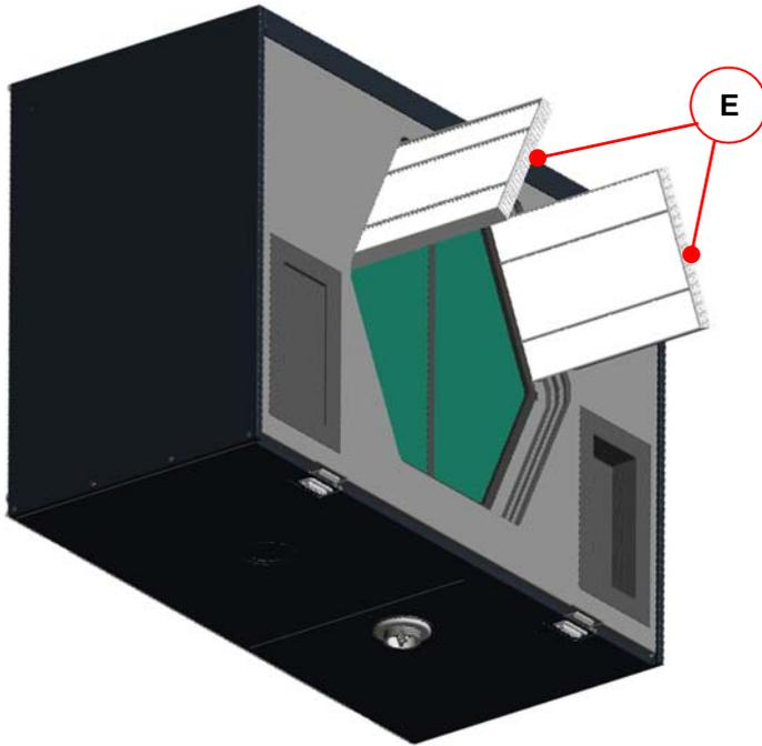
Abb. 40: Herausziehen der Filter
