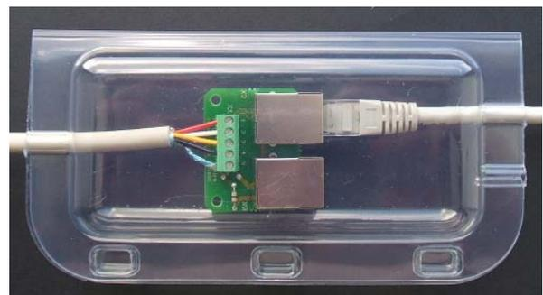
Abb. 32: Gehäuse für Adapterplatine
