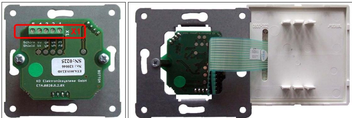
Abb. 35: Anschlussplatine mit Klemme X1 auf UP-Tragplatte; Bandkabel der Anschlussplatine; Rückseite LED-Bedienfolie (von links nach rechts)
