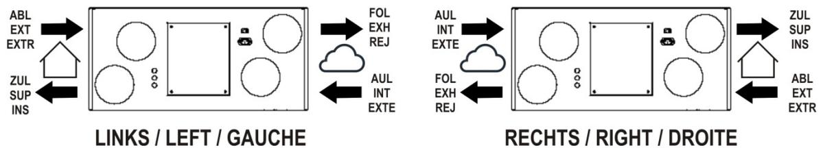
Abb. 26: Anordnung Luftanschlüsse Geräteversion LINKS und Geräteversion RECHTS
