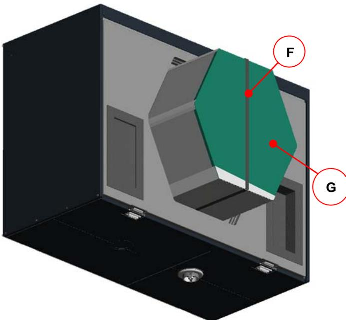
Abb. 41: Entnehmen des Wärmetauschers
