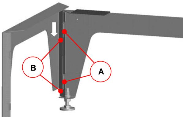
Abb. 22: Fixierung der beiden Fußteile
