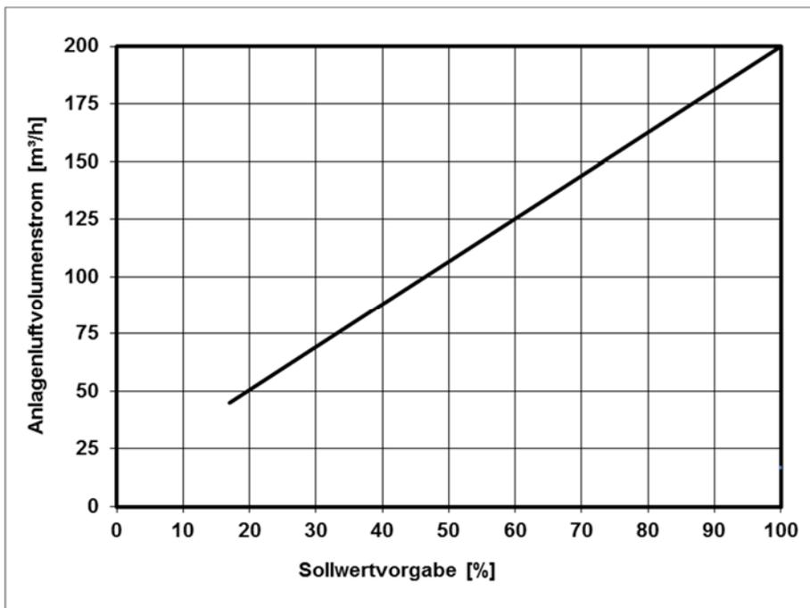
Abb. 36: Diagramm 1, Einstellwerte Nennluftvolumenstrom FOCUS mit Lüfterstufe 2 (LS2)
