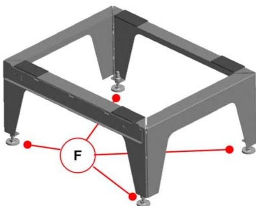
Abb. 25: Justieren des Montage-Sockels
