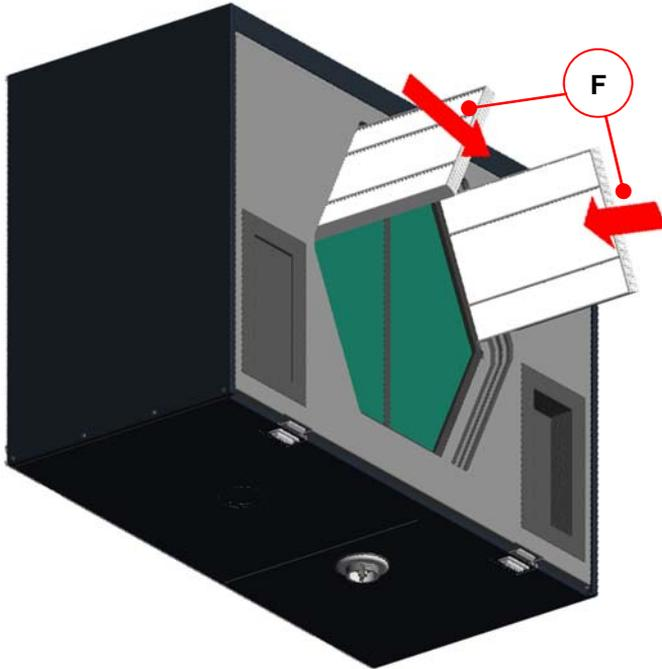
Abb. 13: Einsetzen der neuen Filter entsprechend der Durchströmungsrichtung
