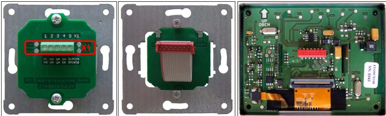
Abb. 33: Anschlussplatine mit Klemme X1 auf UP-Tragplatte; Bandkabel der Anschlussplatine; Platine TFT-Touchpanel (von links nach rechts)
